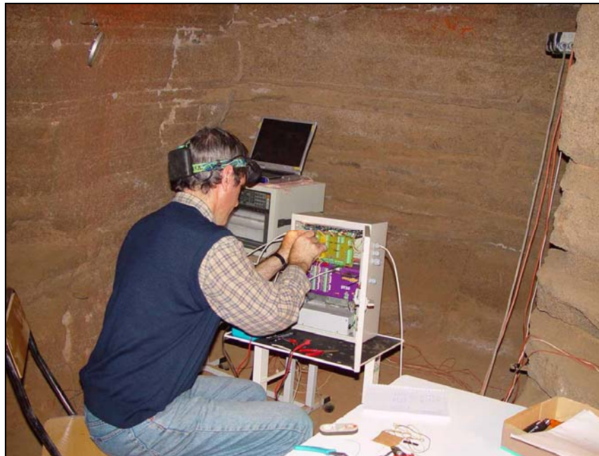
Ajuste de los equipo de control microclimático en Cueva Pintada
